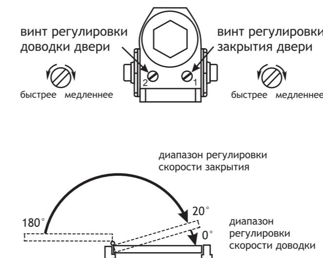
Закрытие и доводка регулируются 2 винтами. Сначала отрегулируйте скорость закрытия, далее скорость доводки двери.
